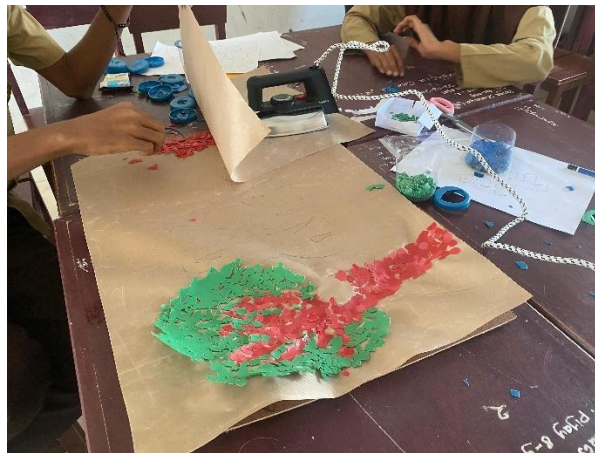
Gambar 3. Proses produksi panel menggunakan Teknik laminasi termal (setrika dan heat gun ).
